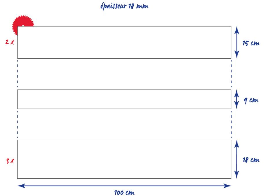
En suivant le plan ci-dessus, découpez les planches à l'aide d'une scie circulaire.
