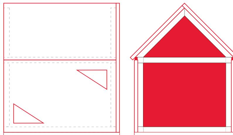
Vissez l'habillage avec les tasseaux par l'intérieur de la cabane. On ne verra alors aucune vis de l'extérieur.
