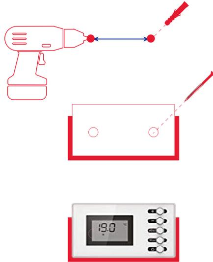
En suivant le plan fourni avec le sèche-serviettes, tracez les zones de fixation du support du boîtier. Percez, mettez les chevilles et fixez le support puis le boîtier.
